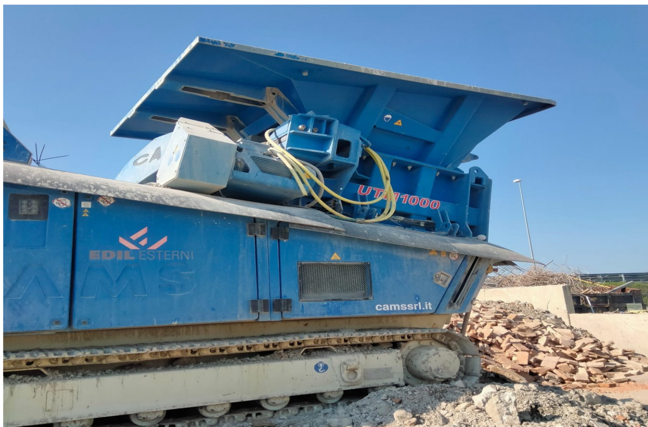
Fig.SIA04_12 Sistema di abbattimento delle polveri installato su trituratore CAMS UTM 1000
